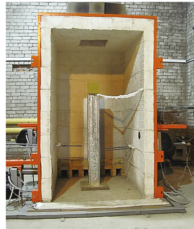
Универсальная печь для огневых испытаний строительных конструкций
