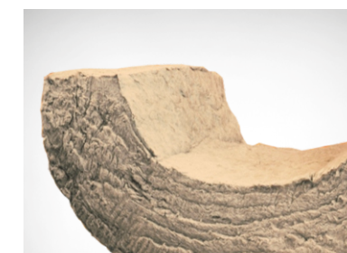
Холсты из базальтовых супертонких волокон БСТВ
