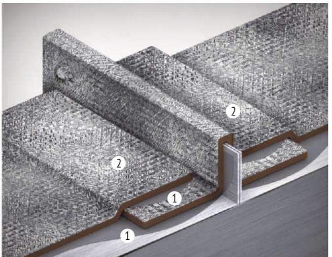
Схема защиты фланцевого соединения воздуховода
