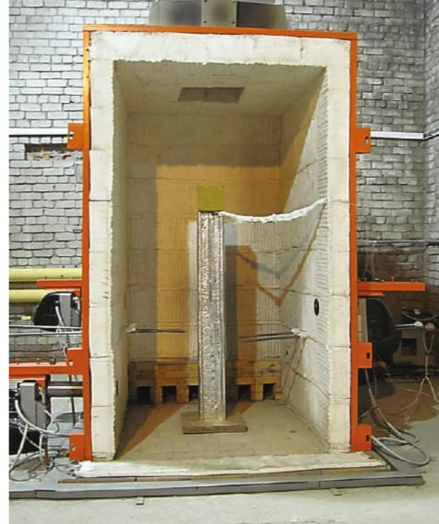
Универсальная печь для огневых испытаний строительных конструкций
