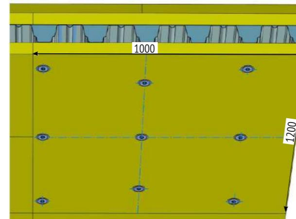
**Схема разметки плит EURO-ЛИТ150 размерами 1000x600x40**
