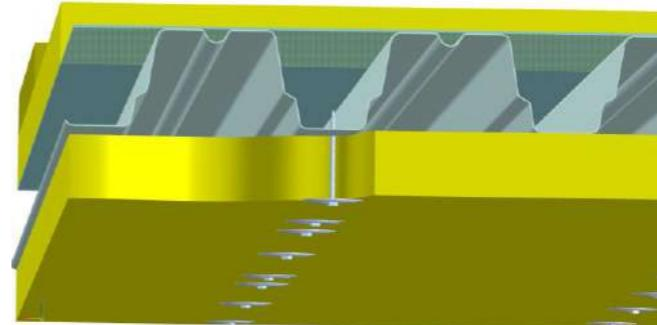
Раскрой плит EURO-ЛИТ в зависимости от геометрических параметров защищаемой поверхности конструкции производится ручным или электромеханическим инструментом. Для более плотного прилегания смонтированных плит, следует соблюдать прямолинейность раскроя.
