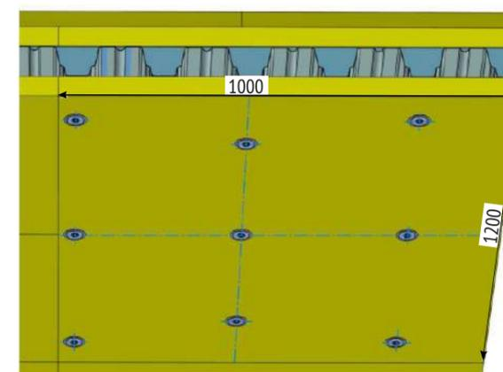
**Схема разметки плит EURO-ЛИТ150 размерами 1000x600x40**
