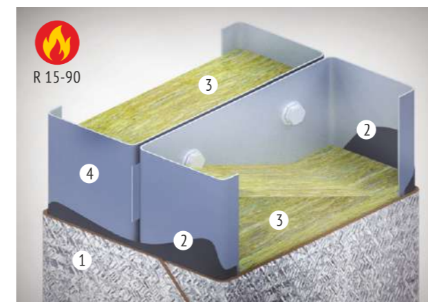
Огнезащита конструкций из профилей, собранных двугавром 1. Материал рулонный МБОР-Ф 2. Огнезащитный состав «ПЛАЗАС» 3. Огнезащитная плита «ЕВРО-ЛИТ» 4. Холодногнутой оцинкованный профиль ЛСТК
