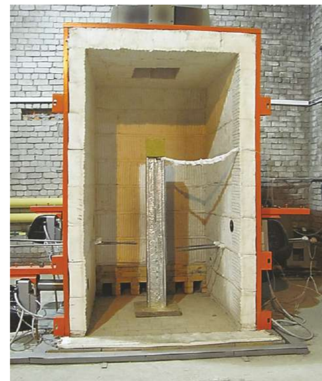
Универсальная печь для огневых испытаний строительных конструкций
