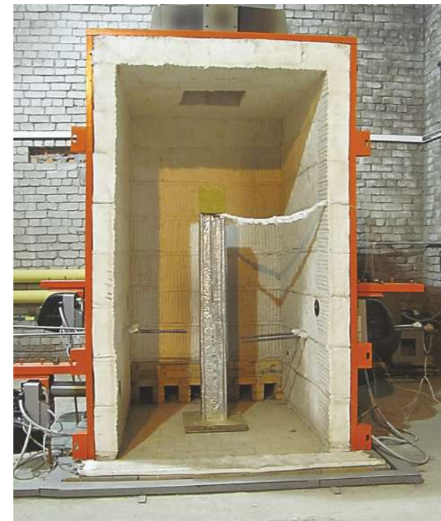
Универсальная печь для огневых испытаний строительных конструкций
